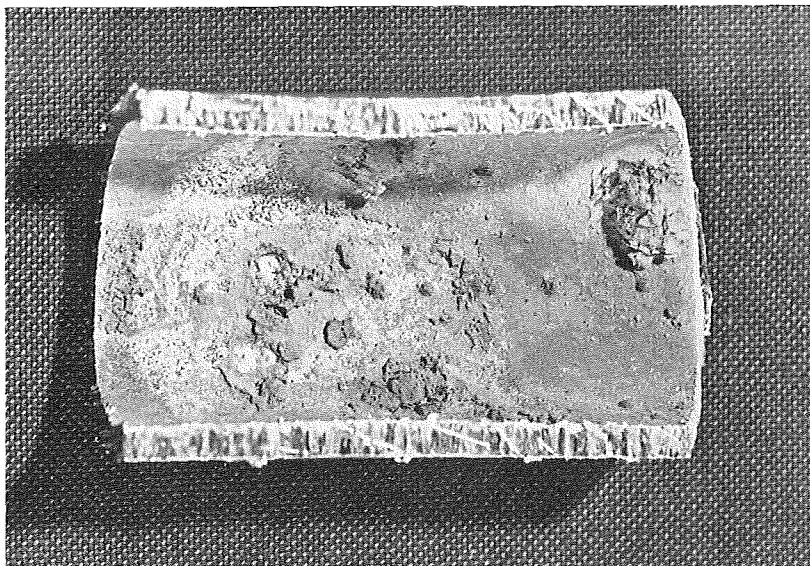
Fig. 23. Grubetæring i aluminiumrør for afsaltet vand, alder 2 år. Årsagen er aflejring af rust fra en støbejernspumpe i systemet.
